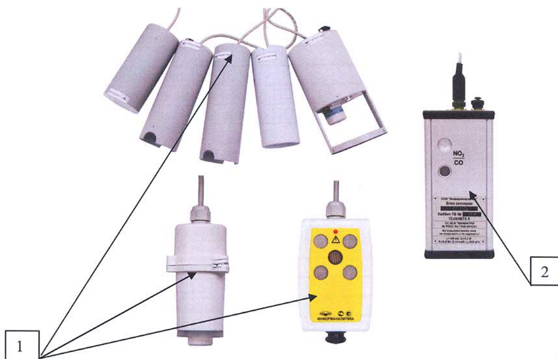
Рисунок 9 – Внешний вид выносных блоков датчиков переносных газоанализаторов
