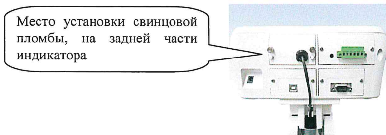
Рисунок 2 — Схема пломбировки от несанкционированного доступа
